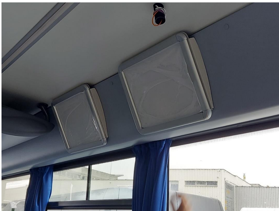
Príklad správneho umiestnenia a orientácie dvojice vývesných informačných plôch v novom vozidle
